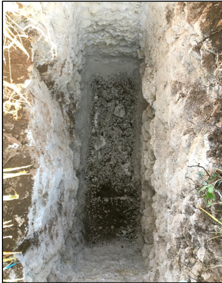
Fosse F1 (prof. 2,05 m) : calcaire graveleux en bancs pluridécimétriques puis décimétriques et altérés, sous 0,50 m de terre végétale limono-argileuse à graviers calcaires
