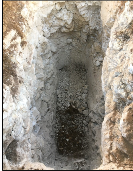
Fosse F2 (prof. 2,00 m) : calcaire graveleux en bancs pluridécimétriques puis décimétriques et altérés, sous 0,30 m de terre végétale limono-argileuse à graviers calcaires
